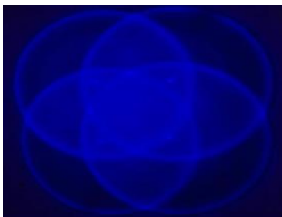
Сурет 4. Таратқыштан 1 м қашықтықтағы оптикалық жарықтандырудың суреті.
